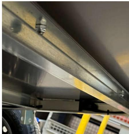
Ni rivet, ni vis auto-perforante! Plancher est fixé avec des vis inox et des écrous frein pour permettre une meilleure solidarité entre ce dernier et le châssis.
