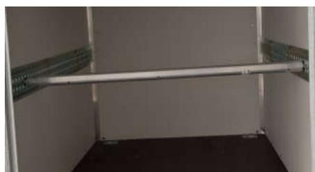
Barre d'arrêt de chargement. Permet de bloquer le chargement, de le fixer afin qu'il n'influe pas sur comportement routier de la remorque. Spécialement conçue pour exercer l'effort approprié à la carrosserie de la remorque. Réf : K071954
